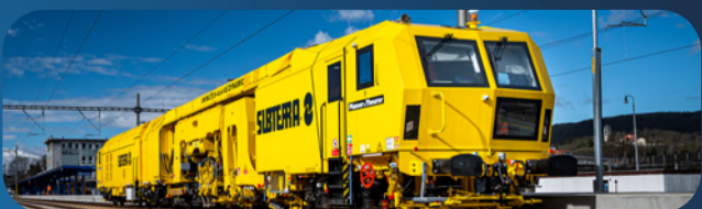
Subterra | Automatická strojní podbíječka UNIMAT 09-4x4/4S DYNAMIC
